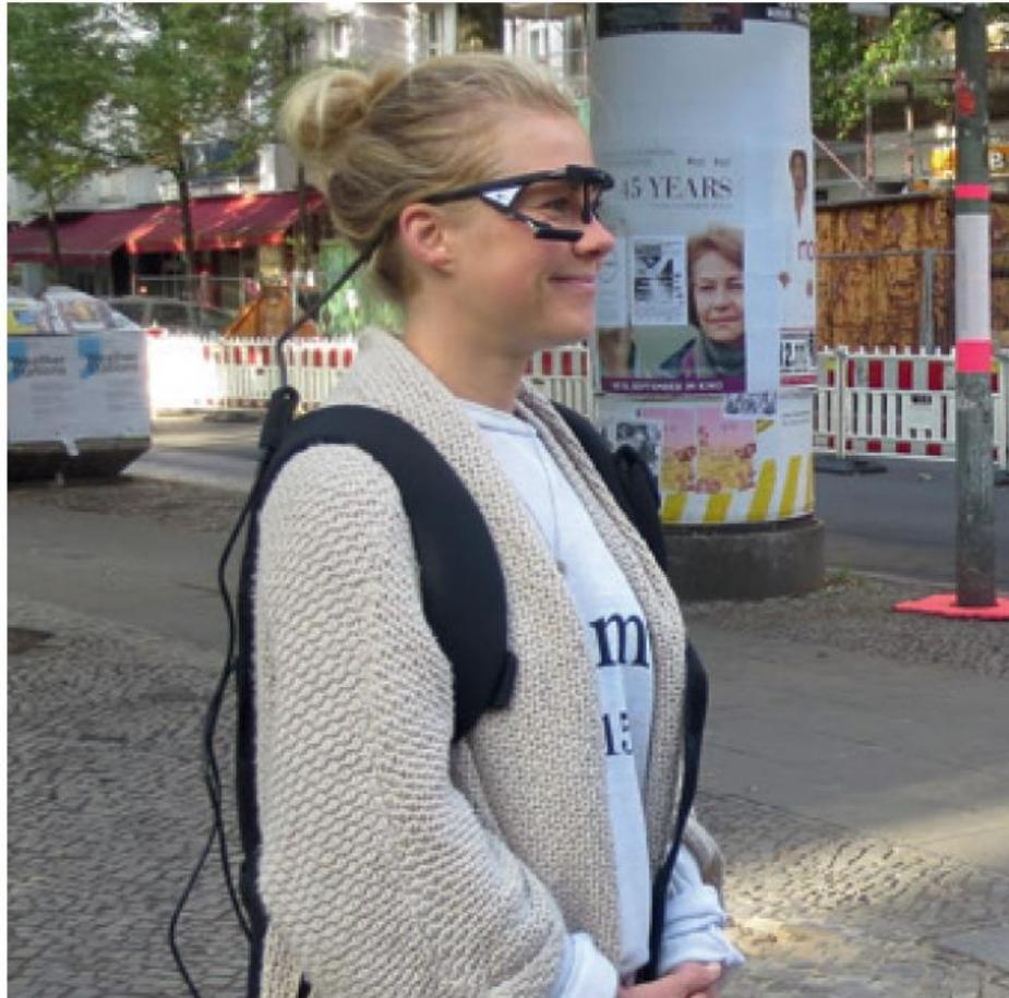
Abbildung 10: Probandin mit mobilem Eye Tracker (Blickbewegungs-Messsystem)
